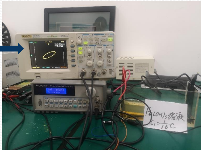
图3 隔板旋转角度-不同浓度Fe(OH) 3 胶体动态伏安特性K曲线
